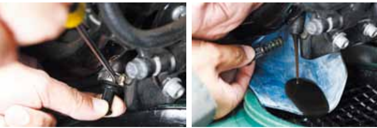
エンジンオイルはドレンプラグではなくドレンホースから排出する。以前のスポーツスターはフレームに溶接された鉄棒にホースを差し込み固定していたが、近年のモデルはホースエンドに樹脂キャップが固定される。十分な暖気後にオイルは抜こう。
