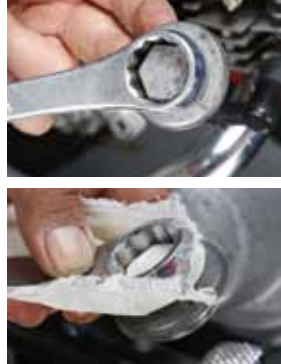
ここではスーパーカブのタペットキャップを外してカムシャフトやロッカーアーム周りにスプレーを吹き付けた。寸法合致した良質工具を使うのももちろん、ガタが出るときにはウエス越に工具を使うのも良い。
