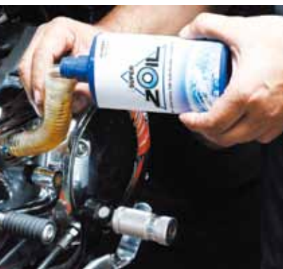
エンジンオイル容量はモデルにより異なるので作業前に確認しておこう。スポーツスターはフィルター交換次第で2リットル以上3リットル未満のようだ。一気に入れないように!!
