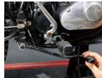
ブレーキペダルを取り外したついでにブレーキスイッチの作動状況や周辺パーツのコンディションも確認しておこう。摺動部に直接グリースアップしてからペダルを復元した。
