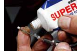
ハンドルパイプエンドの曲がりや転倒時に発生したバリが原因でスロットルパイプがスムーズに作動しない例は多い。点検後、スムーズなら復元だ。タイヤを引っ掛ける部分は当然だが、スロットルワイヤーは引っ張り出してインナーにグリースを塗り込もう。
