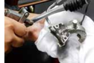
乗り放しだったバイクはもちろん、普段メンテナンスしていてもオフロード走行が多いバイクでは、スロットルハウジング内に水分やドロが入り作動性が低下している例が多い。スロットルハウジングへのグリースアップは定期的な実践項目だと考えよう。
