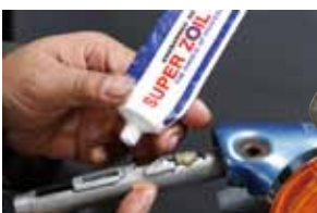
スロットルのスライド部分は粘度が低いオイルよりも保持性が高いグリースを塗布するのがベターである。スーパーカブのスライドスロットルにはスーパーゾイルグリースを利用した。
