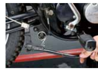
リンク式チェンジペダルピボットやブレーキペダルピボットは、カテゴリーや機種を問わずグリースアップポイントのひとつである。リアブレーキペダルは取り外して作業しよう。
