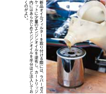
カートリッジ式オイルフィルタは専用のカップレンチがあると取り外しが楽だ。フィルタ周りがかぼれたオイルで汚れないようにフィルタ脱着時は周辺を養生し、締め付け座はきれいなウエスで拭き取ろう。
