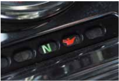
まずはオイルタンクに2リットルほど注入し、エンジン始動直後はアイドリングを続ける。オイルプレッシャースイッチの点灯→消灯も始動直後に確認しよう。スーパーゾイル・エコはオイル容量に対して5%の添加だ。
