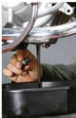
ディップスティックでオイル量を確認するときにはキレイなウエスでオイルを拭き、同時にエンジンオイルの臭いも嗅いでみよう。キャブのオーバーフローが内向きに起るとエンジンオイルにガソリンが混ざってしまい面倒なことになる。
