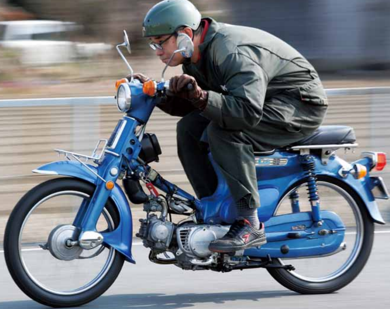
しばらくオイル交換しておらず、注入量も多かったせいで、本来の走りではなくエンジンの回り方が重々しかったスーパーカブ。オイル交換後には気持ち良く軽やかなエンジンフィーリングに変わった。
