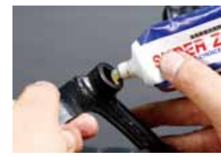
モデルグレードによっても違うが原付クラスなら鉄部品同士で摺動。中型クラスならペダル側にプッシュが圧入され、大型モデルの中にはニードルベアリングが組み込まれる仕様もある。
