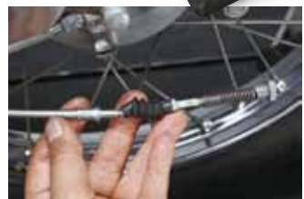
ブレーキレバーの作動レスポンスが今ひとつだったため、フロントブレーキケーブル内にもオイルスプレーを吹き付けた。あまりに汚れが酷いときにはパーツクリーナーで内部洗浄した後にオイルスプレーを吹き付けるのがベストだ。
