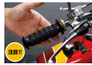
転倒によりパイプコンディションが悪くなり、スロットルが重くなっているケースが多々ある。ハンドルパイプの汚れはパーツクリーナーやガソリンを塗布したウエスでしっかり拭き取る。スロットルパイプ内の汚れもロングドライブ+ウエスで拭き取る。
