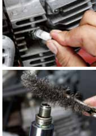
オイル交換と同タイミングでスパークプラグの点検も実施しよう。プラグレンチを掛ける前にプラグ周囲の汚れはエアブローもしくは洗車にて洗い流そう。ススけていたり汚れが堆積しているときにはワイヤブラシでクリーンナップしよう。
