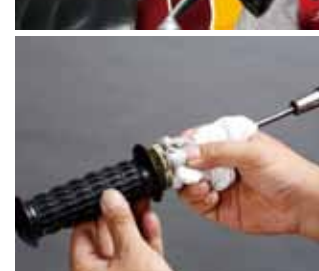
転倒によりパイプコンディションが悪くなり、スロットルが重くなっているケースが多々ある。ハンドルパイプの汚れはパーツクリーナーやガソリンを塗布したウエスでしっかり拭き取る。スロットルパイプ内の汚れもロングドライブ+ウエスで拭き取る。
