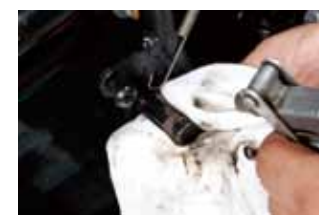
フレームに溶接されているピボットシャフトにパーツクリーナーを吹きつけウエスで汚れを拭き取る。このピボットコンディションによってもそのバイクの履歴、使われ方が想像できる。
