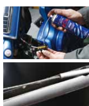
ケーブルエンドにケーブルインジェクターツールをセットしてオイルスプレーを吹き付けよう。各種ケーブル内にオイルを巡らせることで作動性が驚くほど高まる。反対側からオイルのしぶきが出ればOKだ。
