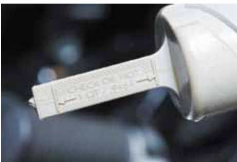
エンジン暖気後に車体を直立させた状態でオイルタンクのディップスティックを確認する。フル領域いっぱいまでオイルを入れるとブリーザーから吹き返しやすいので注意しよう。
