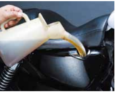
エンジンオイル容量はモデルにより異なるので作業前に確認しておこう。スポーツスターはフィルター交換次第で2リットル以上3リットル未満のようだ。一気に入れないように!!
