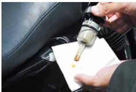
ハーレーVツインエンジンはドライサンプシステムを採用しているため、エンジンオイルのコンディションはオイルタンクキャップのディップスティックで確認することができる。
