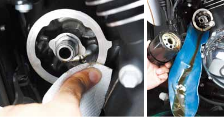
カートリッジ式オイルフィルタは専用のカップレンチがあると取り外しが楽だ。フィルタ周りがかぼれたオイルで汚れないようにフィルタ脱着時は周辺を養生し、締め付け座はきれいなウエスで拭き取ろう。
