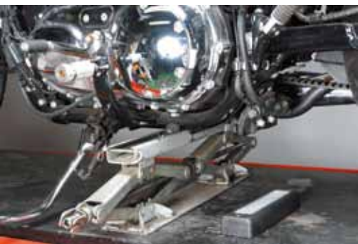
ハーレー・ダビッドソン各車はフレームのダウンチューブでリフトアップすることで安定したオイル交換作業を実施できる。2連パンタジャッキなどがあるとたいへん便利だ。
