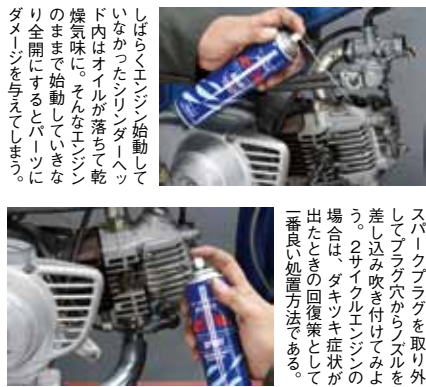
ここではスーパーカブのタペットキャップを外してカムシャフトやロッカーアーム周りにスプレーを吹き付けた。寸法合致した良質工具を使うのももちろん、ガタが出るときにはウエス越に工具を使うのも良い。
