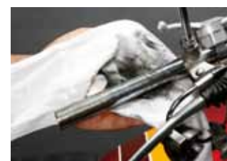
乗り放しだったバイクはもちろん、普段メンテナンスしていてもオフロード走行が多いバイクでは、スロットルハウジング内に水分やドロが入り作動性が低下している例が多い。スロットルハウジングへのグリースアップは定期的な実践項目だと考えよう。
