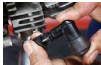
プラグを復元してキャップを差し込む前に、ハイテンションコードとプラグキャップの接続がしっかり行われているか確認しておこう。キャップを押し付けながら回して確実に固定しよう。
