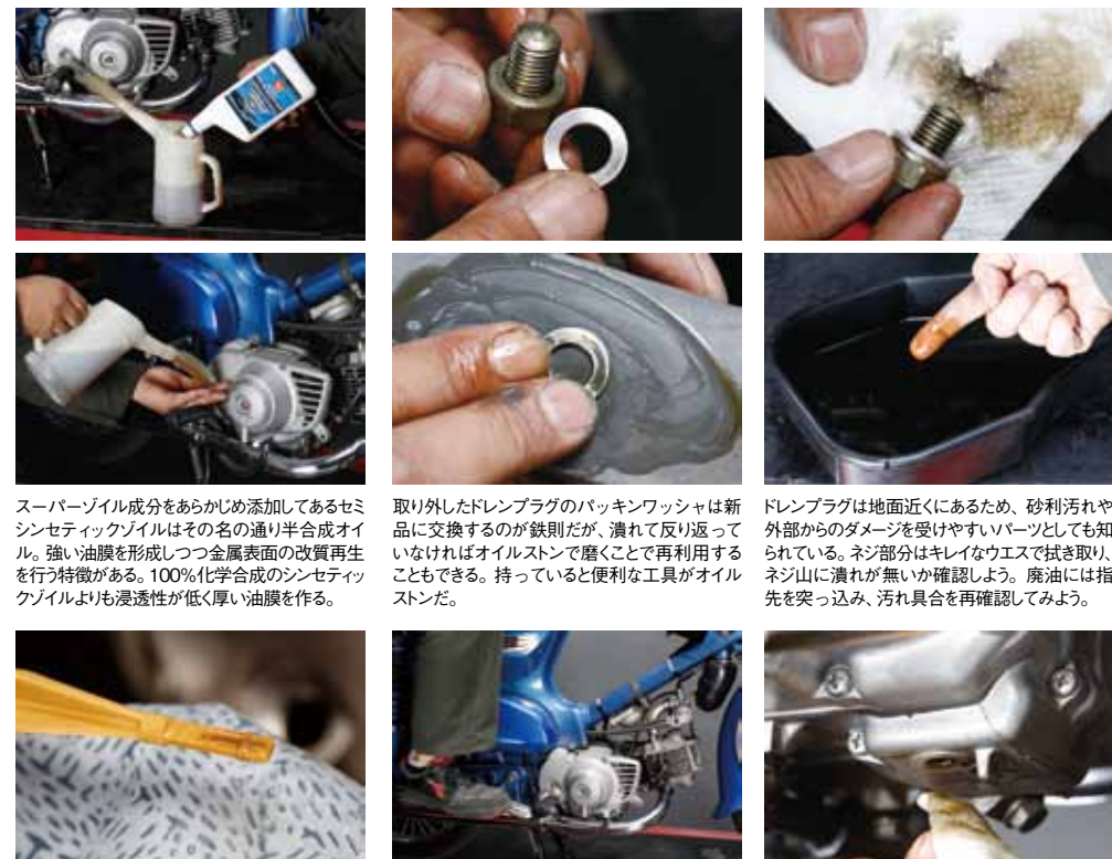
エンジンオイルを確認し、必要に応じてオイルを追加注入しよう。この段階で新しいオイルが汚れ気味になっている際には、次のオイル交換時にフラッシングを行うのがベストである。
