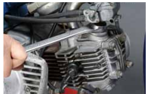
長年乗られていなかったバイクのエンジン・始動前はもちろん、くたびれ気味なエンジンの内部パーツに直接吹き付けることで、潤滑性の向上を図れるのと同時に、現状コンディションを明確に知ることができる。
