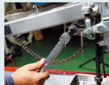
スイングアームのピボットシャフト以外に、スイングアーム側ピボット、フレーム側リンクピボット、リアサスロア側などなど4本のシャフトをすべて差し込んでからナットを止め付ける。トルク管理はボルトの太さで50N・mと60N・m。
