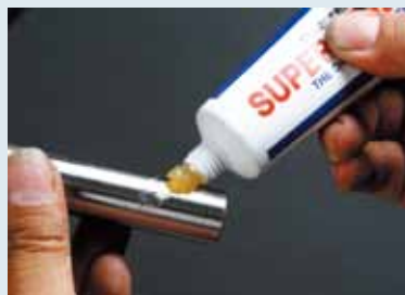
スイングアーム側ピボットやリンクを組み合わせる他の2箇所はピン×ブッシュの摺動軸受けとなっていた。グリースの塗布量が著しく少なく、ピンの一部はすでに強く擦れ合っていてピカピカに輝いていた。KLX125も明らかにグリースの塗布が少ないようだ。
