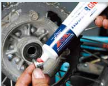
リアホイールを復元する前に両サイドのカラーを抜き取り、キレイなウエスで汚れを拭き取る。そして、ダストシールリップの当たる部分にスーパーズイルラバーグリースを適量塗布する。
