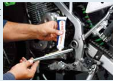
スイングアーム側ピボットやリンクを組み合わせる他の2箇所はピン×ブッシュの摺動軸受けとなっていた。グリースの塗布量が著しく少なく、ピンの一部はすでに強く擦れ合っていてピカピカに輝いていた。KLX125も明らかにグリースの塗布が少ないようだ。
