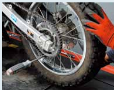
ドライブチェーンとスプロケットの間にドライバーを噛み込ませてチェーンを突っ張り、その状態でリアアクスルを締め付け固定する。このようにすることでチェーンアジャスターの遊びが無くなるのだ。
