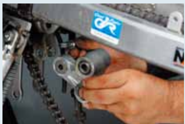
分解したリンク周辺部品は洗浄してから各部に適量のグリースを塗布。インナーカラーやブッシュピンを差し込んだ状態で復元開始。タイヤからドロや小砂利のハネ返しをダイレクトに受ける場所だ。
