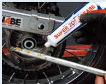
リアホイールアクスルもやはり油付けがほとんど無く乾燥していたので、ウエスで拭き取ってからスーパーズイルグリースを少量塗布して指先で伸ばし、組み立て性の向上と同時に防錆処理を施した。
