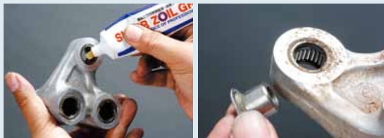
三角形のリンクブロックには摺動性・作動性向上のためにベアリングが組み込まれている。このKLX125の場合はリアショックユニットの下側締結部分にニードルローラーベアリングとダストシールが圧入されていた。汚れを洗浄してからグリースアップを施した。
