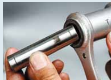
スイングアーム側ピボットやリンクを組み合わせる他の2箇所はピン×ブッシュの摺動軸受けとなっていた。グリースの塗布量が著しく少なく、ピンの一部はすでに強く擦れ合っていてピカピカに輝いていた。KLX125も明らかにグリースの塗布が少ないようだ。
