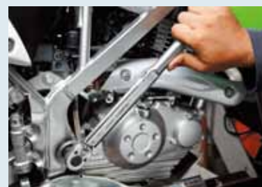
分解したリンク周辺部品は洗浄してから各部に適量のグリースを塗布。インナーカラーやブッシュピンを差し込んだ状態で復元開始。タイヤからドロや小砂利のハネ返しをダイレクトに受ける場所だ。
